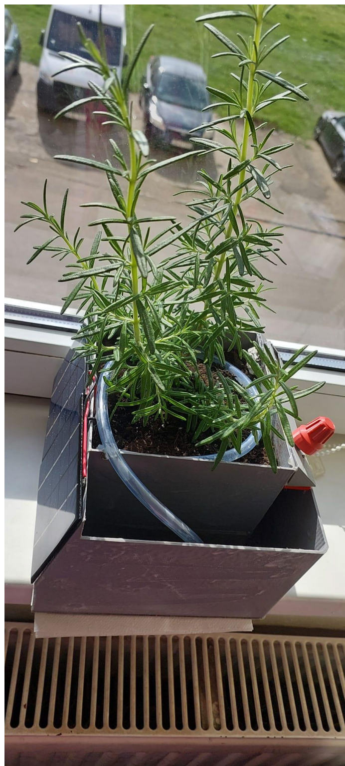
Fig. 3 Sistemul ghiveci autonom/smartpot În imagine se pot vedea panourile solare
