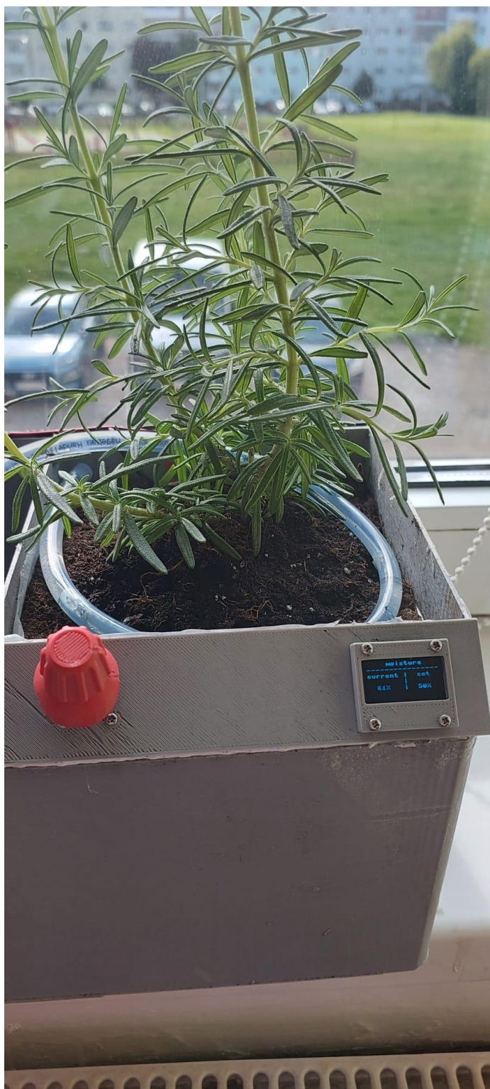
Fig. 2 Sistemul ghiveci autonom/smartpot În imagine se poate vedea ecranul de monitorizare
